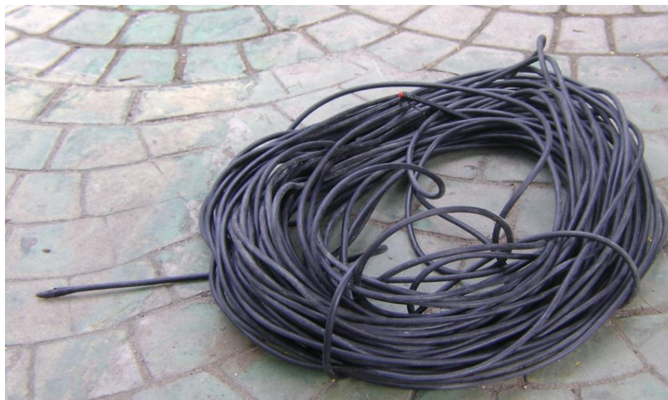
CIEN METROS DE CABLE COAXIAL RG 8
